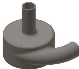
Figura 2-2 Aspecto geral do DAV desenvolvido pelo Laboratório de Bioengenharia e Biomateriais do IFSP-SPO
