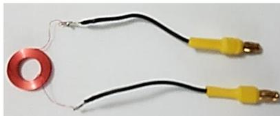
Figura 4-4 - Bobina conector banana plug macho.
